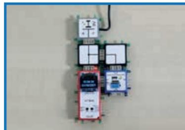
Messung von Temperatur und Luftfeuchtigkeit mit DHT11
