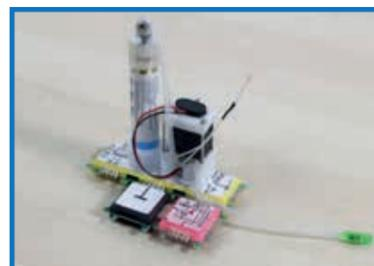
Inbetriebnahme der Wasserstoff-Brennstoffzelle
