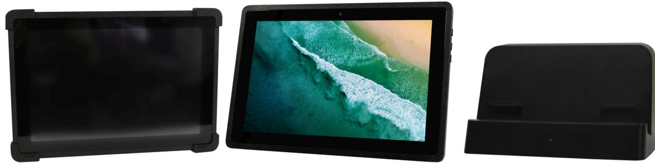
Rugged Displays sind speziell für den rauen Einsatz geeignet, z.B. Gastronomie oder Logistik. Die zugehörige Ladestation hat 2 USB Anschlüsse für Maus und Tastatur und einen PoE Netzwerkanschluss worüber die Tablets auch geladen werden können. Sobald das Gerät aus der Ladestation genommen wird, schaltet es automatisch auf WLAN Empfang um.
