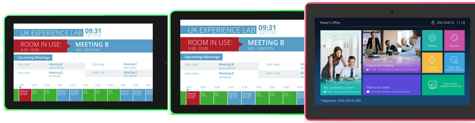
Die ALLNET Meetingraumdisplays sind speziell als Raumbeschilderung geeignet. Durch die eingebauten LED Leisten können bestimmte Situationen oder Zustände einfach signalisiert werden. Hierfür stellen wir eine API zur Ansteuerung zur Verfügung. Ebenso ein Besonderheit ist der verbaute NFC Reader in der Front der Displays, mit welchem es möglich ist ein Zeitterminal zu verwirklichen oder auch Raumbuchungen mit Zugangskontrolle zur Verfügung zu stellen..
