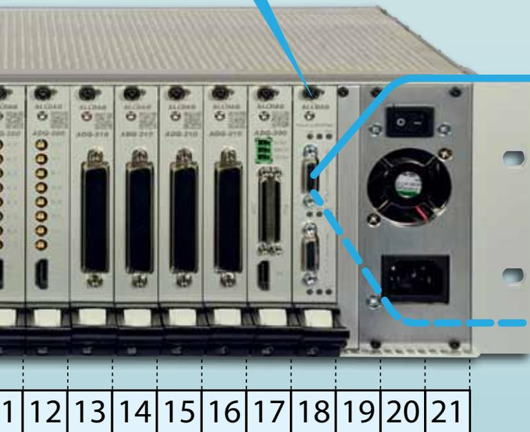
mindestens ein System-Slot für eine CompactPCI-Bridge oder Slot-CPU.
