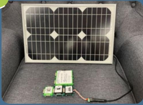
Als erstes muss der **Akku geladen** werden und danach können wir das **Handy aufladen**. Um zwischen den beiden Möglichkeiten zu **wechseln**, bauen wir einen **Umschalter** ein.
