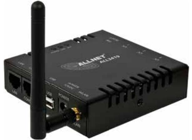
Die ALL3419 IP Sensorzentrale ist eine flexible und kostengünstige Lösung zur Temperaturerfassung per Netzwerk. Durch seine äußerst kompakte Bauweise ist der Einsatz auch an schwer zugänglichen Stellen möglich.
