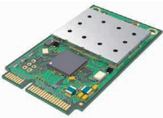
Die R11e-LR8 ist eine neue Konzentration Gateway Karte für LoRa®-Technologie im Mini-PCIe-Formfaktor und basiert auf dem Semtech SX1301-Chipsatz. Er ermöglicht LoRa®-Konnektivität für jedes MikroTik Produkt, das über einen mPCIe-Steckplatz verfügt.
