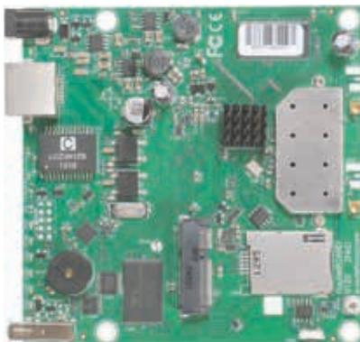
Das RB912UAG-2HPnD Routerboard ist ein sehr vielseitiges Gerät. Es ist ein kleiner drahtloser Router mit einer integrierten 2,4GHz-Hochleistungs-Wireless-Karte und einem zusätzlichen miniPCle Steckplatz für eine 802.11 Wireless- oder 3G Karte. Der Gigabit-Port hilft dabei, das volle Potenzial der drahtlosen 802.11n-Geschwindigkeiten auszuschöpfen.
