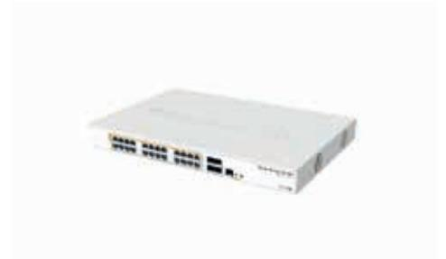
Der CRS328-24P-4S+RM ist ein 28-Port Switch, mit 24 Gigabit-Ethernet-Ports und verschiedenen Leistungsausgabe-Optionen: Passives PoE, niedrig Spannung PoE, 802.3af/at (Typ 1 "PoE" / Typ 2 "PoE+") mit automatischer Erkennung. Die vier SFP+-Ports bieten bis zu 10 Gbit/s Konnektivität über optische Glasfaser- oder Ethernet-Module (nicht enthalten). Der CRS328-24P-4S+RM wird in einem 1U-Rackmount-Gehäuse mit eingebautem 100-240V AC 500W Netzteil geliefert.
