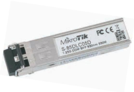
S-85DLC05D ist ein 1,25G SFP Transceiver mit einem 850nm-Dual LC Stecker für bis zu 550 Meter Multimode Glasfaserverbindung mit DDM
