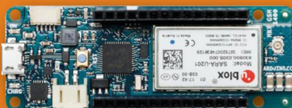
Arduino MKR GSM 1400 wurde entwickelt, um eine praktische und kostengünstige Lösung für Hersteller anzubieten, die ihre Projekte mit minimaler Erfahrung in der Vernetzung um eine globale GSM-Konnektivität erweitern möchten. Es basiert auf dem Atmel SAMD21 und einem SARA-U201 GSM-Modul.
